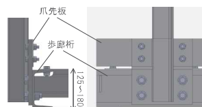
【従来検査路】溶融亜鉛めっき製
