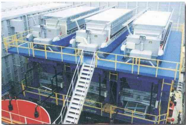
泥水シールド余剰泥水処理 高压薄層フィルタープレスφ2,000 × (10.9m 3 ) × 3台
