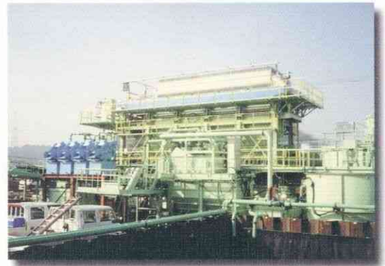
手賀沼浚渫底泥脱水処理 高压薄層フィルタープレスφ2,000 × (14m 3 ) × 1台
